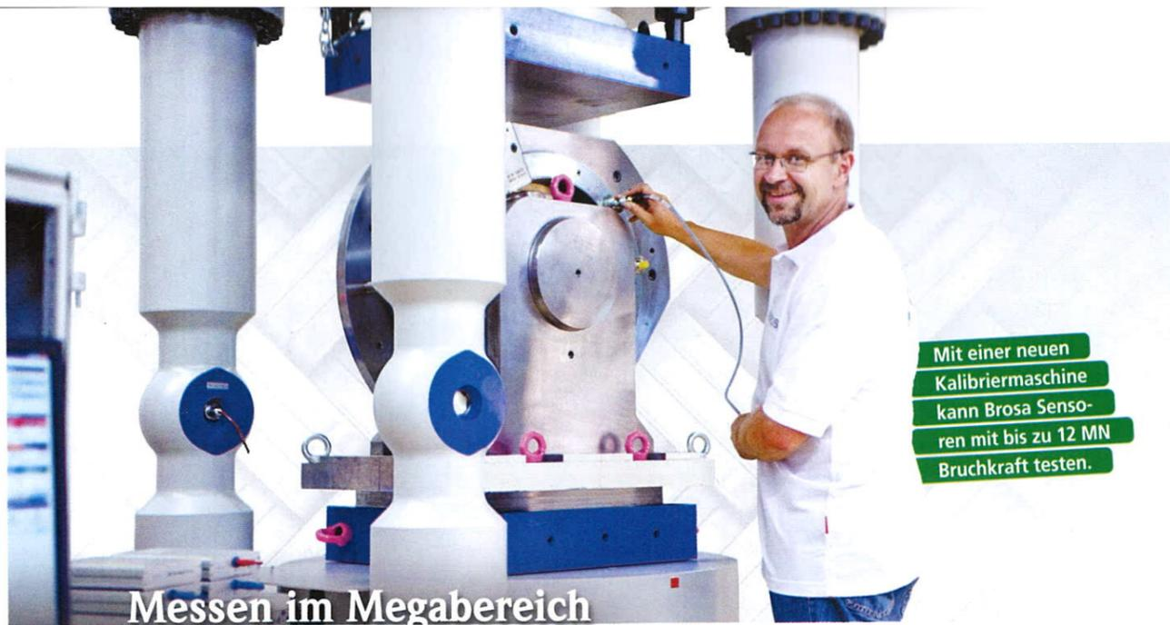
Mit einer neuen Kalibriermaschine kann Brosa Sensoren mit bis zu 12 MN Bruchkraft testen.
