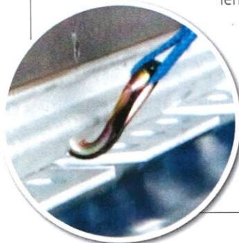
Teil eines umfassenden Sicherungsprogramms: neue-Load-Lock-Leiste für die Montage in Gardinensatteln von Fliegl.
